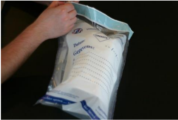
Afbeelding 7: In plaats van een kartonnen doos kan ook een tweede plastic sealbag worden gebruikt.
