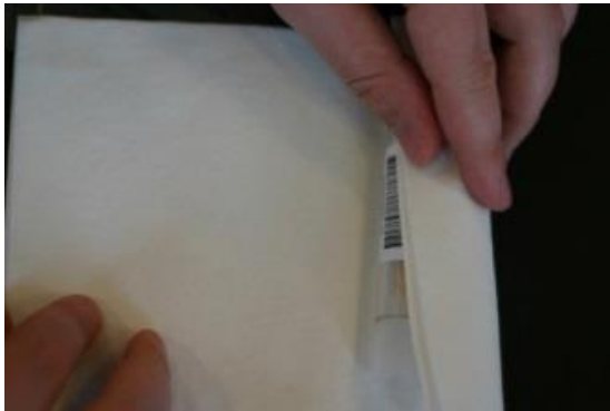
Afbeelding 2: het busje wordt voorzien van absorptiemateriaal
